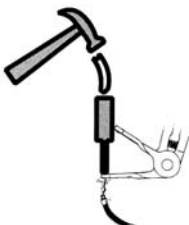
Abb. 4: Alte Kabelhülle entfernen.
