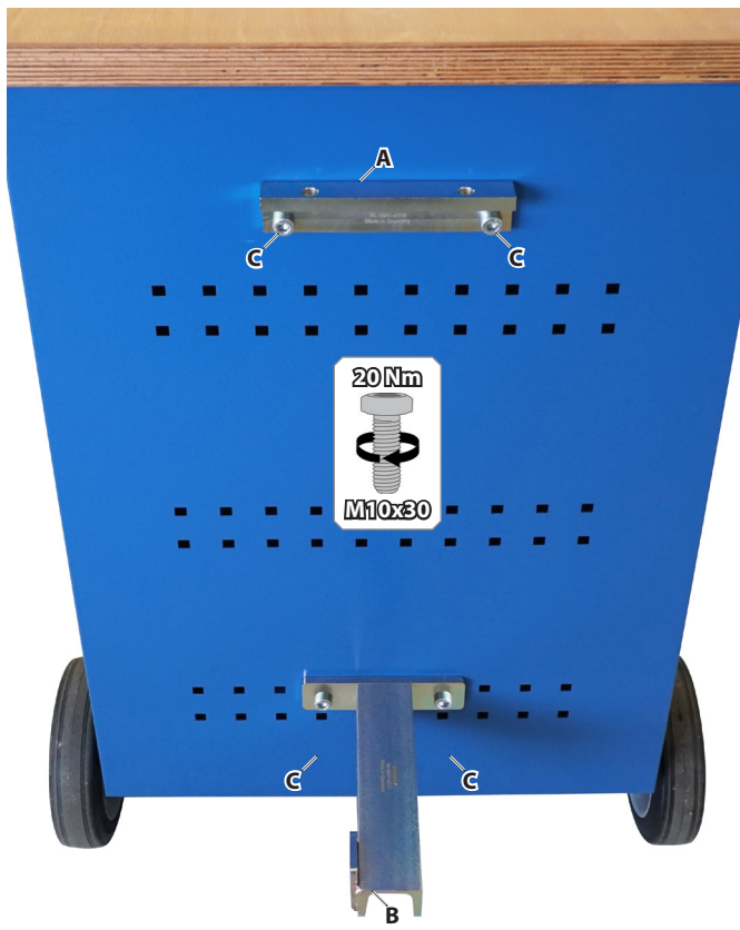
☒ 2: Montage des Federspanners - KL-5501 B am Wandhalter.
