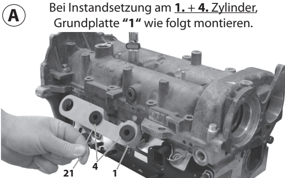
Abb. 20: Grundplatte "1" entsprechend montieren.
