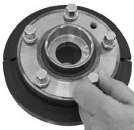
Fig. 9: Installer l'outil. Poser l'unité moyeu/roulement de roue
