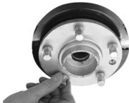
Fig. 5 : Monter l'outil sur le pivot
