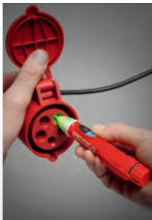
CAT IV 600 V Drehfeldprüfung Grün = Rechtsdrehfeld
