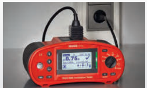
IT 115 bei der Schleifenimpedanzmessung ohne RCD-Auslösung
